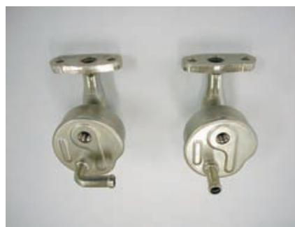
ターボオイルセパレートタンク
